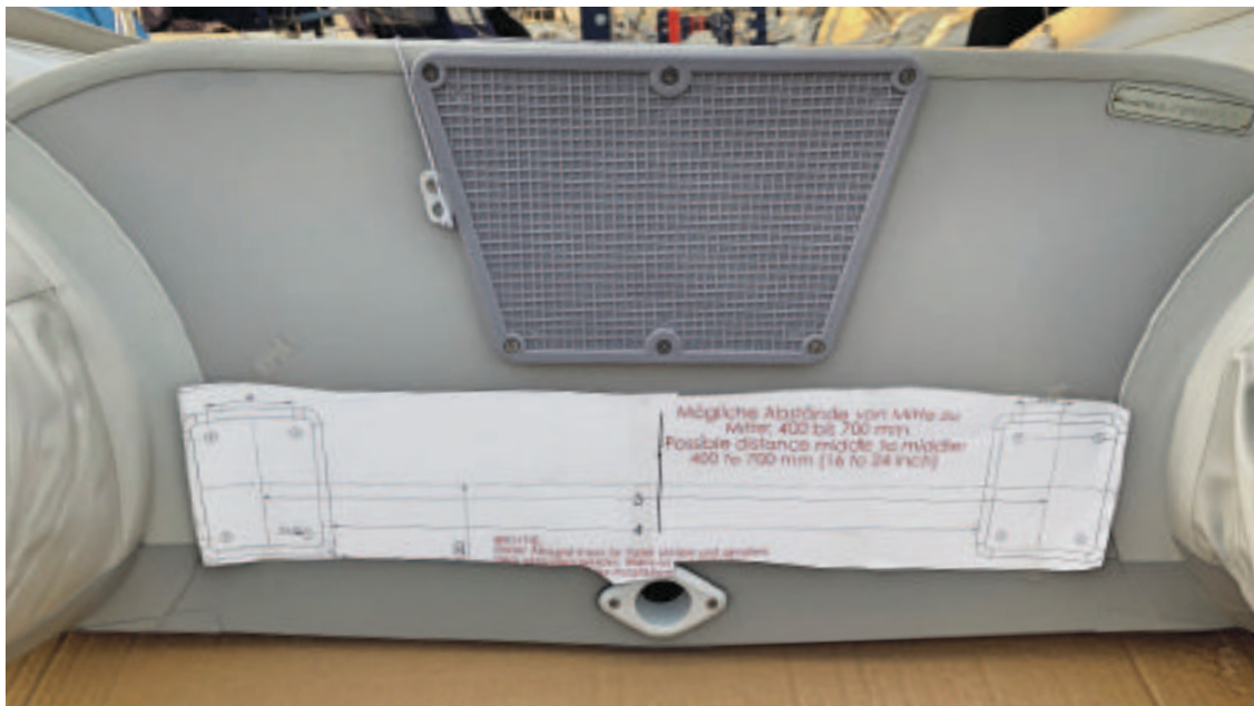
Heften Sie mit Klebestreifen die vorbereitete Bohrschablone an den Spiegel des Beibootes.
