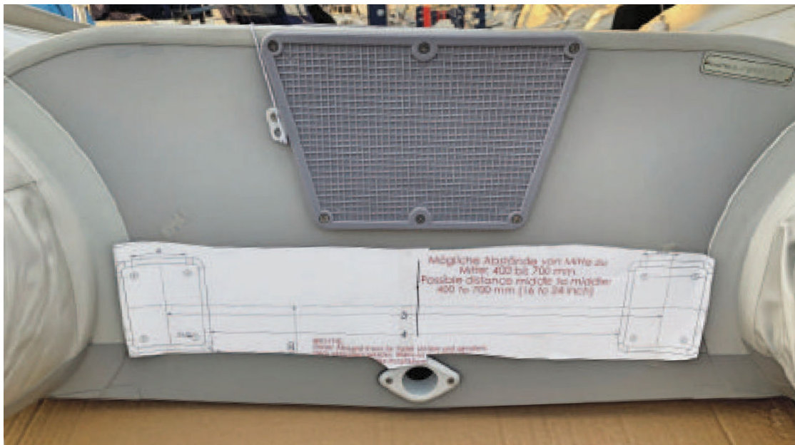
Fixe le gabarit de perçage préparé sur le miroir de l'annexe avec du ruban adhésif.
